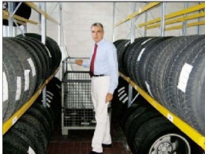
Detlef Hertwig im alten Teil der stationären Regalanlage. Sie nimmt jetzt ausschließlich Räder auf, die größer als 225 sind. Durch dieses Sortieren werden die Langfächer raumoptimiert genutzt. Die Gewichtsbelastung der Reifenträger ist deutlich erkennbar.
