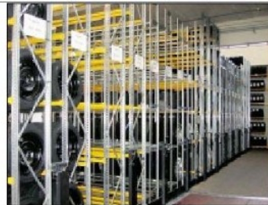
„Hab mein Wagen voll geladen.“ Alte, vorhandene (gelbe Warenträger) und neue Reifenregale auf Verschiebewagen verdoppeln jetzt die Lagerkapazität. Im Hintergrund ist gut zu erkennen, wie durch die Flexibilität der Rad-Mark-Regale einer der Deckenträger umbaut wurde und immer noch fünf Ebenen bestückt werden können.
